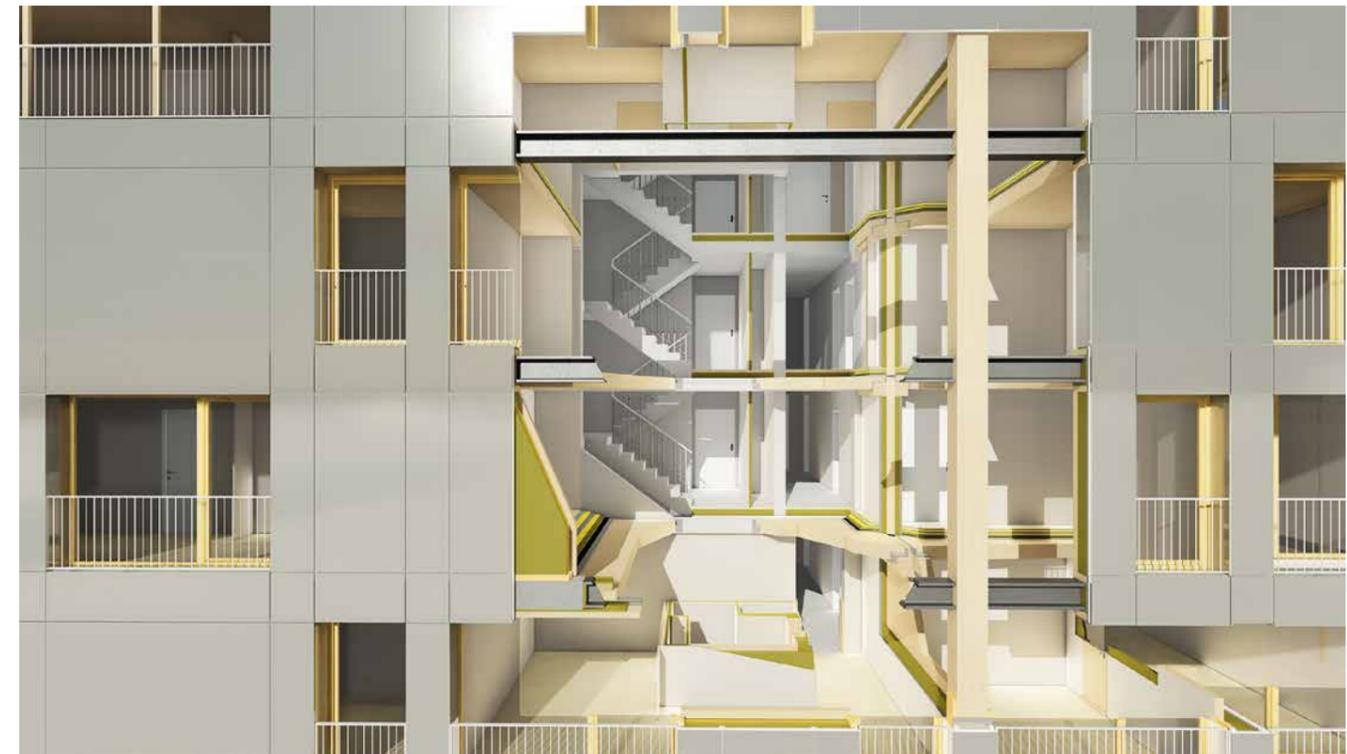
entsteht. Die Überbauung wird durch an der Gebäudeaußenkante angeordnete Stahl-Beton-Verbundstützen getragen.
